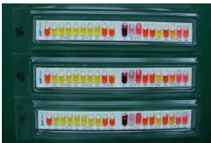
Fot. 10 Test biochemiczny API STAPH szczepów nr 36, 42, 70 (SA 97,8%) Profil numeryczny szczepu nr 36, 42, 70: 6736153 .
