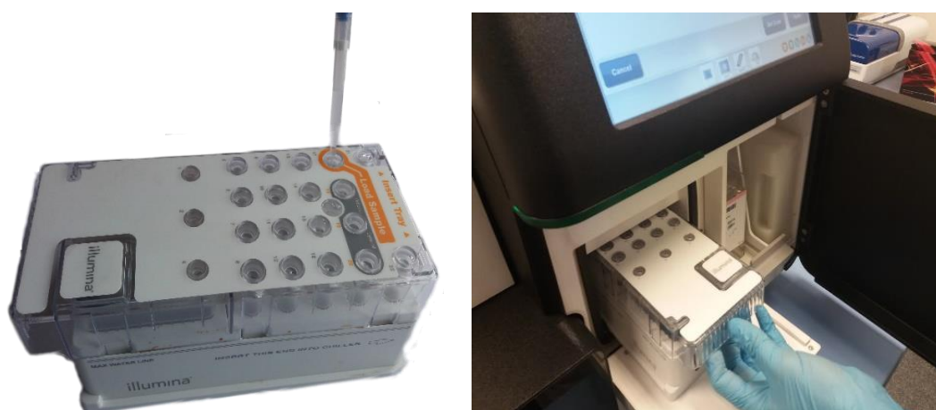
Rycina 19. Nakładanie biblioteki genomowej do wyznaczonego miejsca oraz umieszczanie kasety w sekwenatorze MiSeq.
